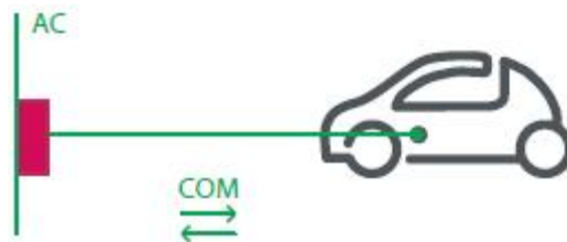
Dispozitiv de protecție în instalație, stație de încărcare dedicată
